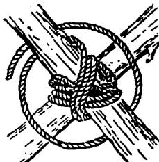
HARÁNTKÖTÉS. Kezdjétek mindkét rúdra kötött peterszeggel. Minden elágazást kössetek körül. Folytassátok feszítőkötéssel, és fejeztétek be szorítónyolcassal.
